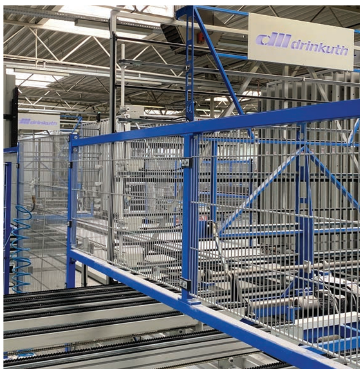
Eine der drei Elemente-Sortieranlagen. Hier: für angeschlagene Rahmen und Flügel. Foto: Drinkuth
